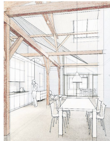
Holztragstruktur im Zentralbau.
