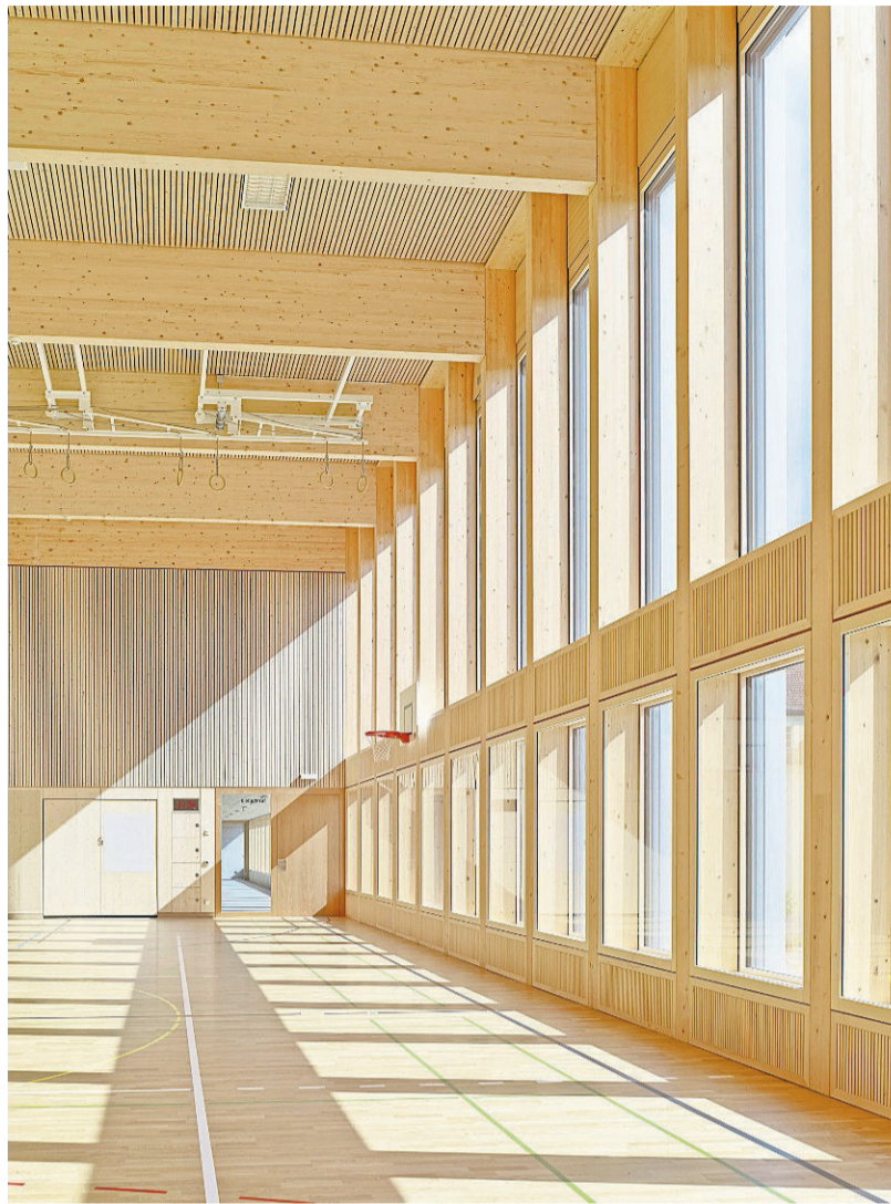
Das Innere wurde in Holzelementbauweise erstellt.
